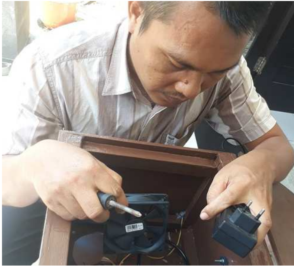
Gambar 19. Perakitan blok-blok komponen penyusun alat Hand Sanitizer Otomatis
